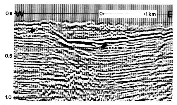
Fig. 2. Ausschnitt aus dem reflexionsseismischen W-E-Profil 74BE10 im Bereich der Develier-Linie. Vertikalskala: Reflexionszeit der P-Wellen.
