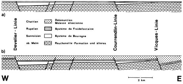
Fig. 5. Schematisches W-E-Profil durch das Delsberger Becken (Höhen ×2).
