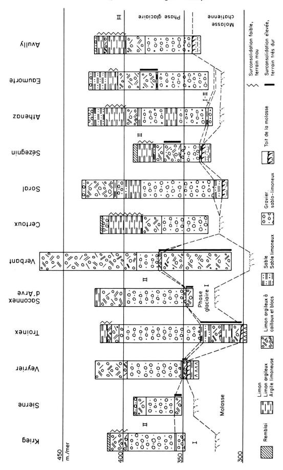
Fig. 6. Profils résumés des sondages exécutés entre Arve et Rhône.
