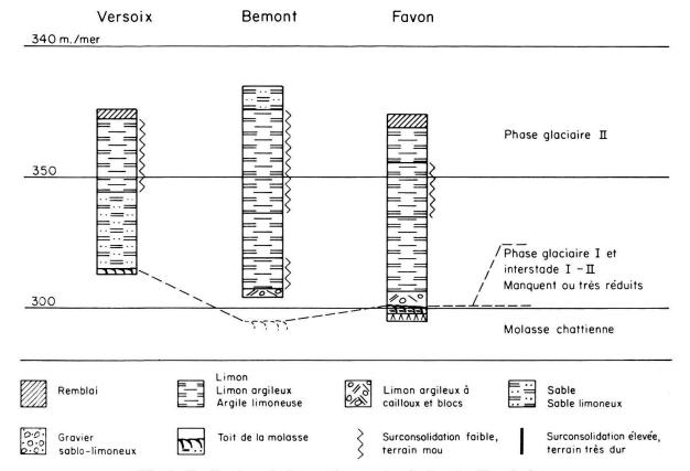
Fig. 5. Profils résumés des sondages exécutés dans le sillon du Lac.
