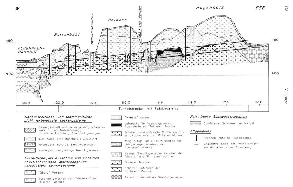
Fig. 2. Geologisches Längenprofil des Hagenholztunnels ( $10 \times$  überhöht).
