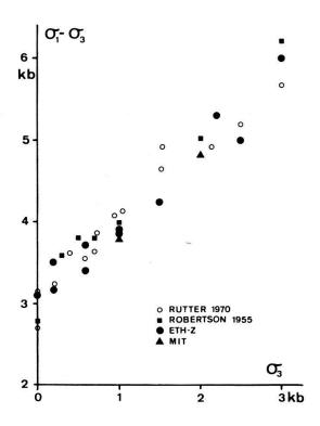
Fig. 3. Differenzspannungs-/Manteldruck-Diagramm für verschiedene Experimente an Solnhofener Kalk, ausgeführt in verschiedenen Labors mit verschiedenen Apparaten und auch (ausser MIT und ETH) verschiedenem Probenmaterial.
