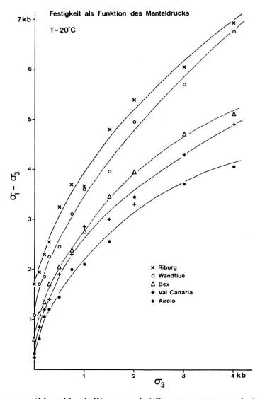
Fig. 6. Differenzspannungs-/Manteldruck-Diagramm bei Raumtemperatur und einer Verformungsrate von 4,5×10<sup>-5</sup>/sec des Anhydrits von 5 verschiedenen Lokalitäten. Jeder Punkt entspricht beim jeweiligen Experiment bei Bruch der maximalen Festigkeit oder bei duktilem Verhalten der Festigkeit bei 10% Verformung.
