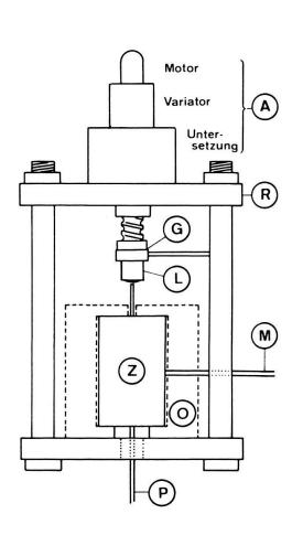
Fig. 1. Schematische Skizze des Deformationsapparates.
