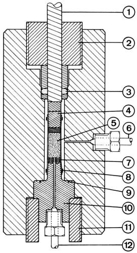
Fig. 2. Schnitt durch die Druckzelle.
