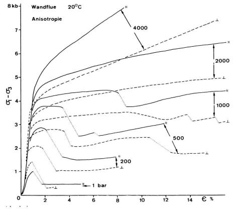
Fig. 11. Einfluss der Anisotropie auf die Festigkeit bei Raumtemperatur und verschiedenen Manteldrucken am Beispiel eines laminierten Anhydrits von der Wandflue. Das Spannungs-/Verformungs-Diagramm zeigt pro Manteldruck je eine Kurve bei  $\sigma_1$  parallel bzw. senkrecht zur Lamination des Anhydrits.
