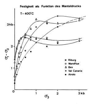
Fig. 9. Differenzspannungs-/Manteldruck-Diagramm bei 400 °C und sonst gleichen Bedingungen wie bei Figur 6.
