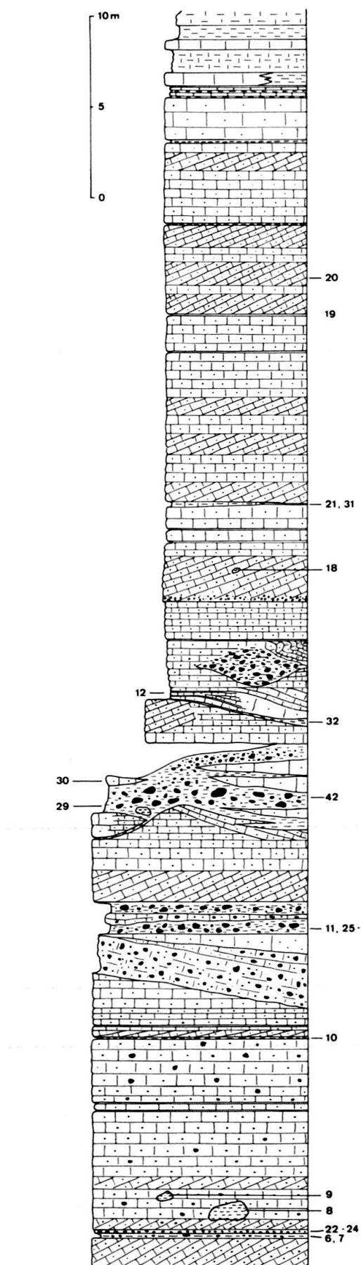
Fig. 1. Stratigraphisches Sammelprofil des Eozäns in den Steinbrüchen östlich von Travedona mit Angabe der Probennummern. Mit schräger Bankungssignatur sind die Partien mit schiefl verlaufenden Klüften und Stylolithen gekennzeichnet.
