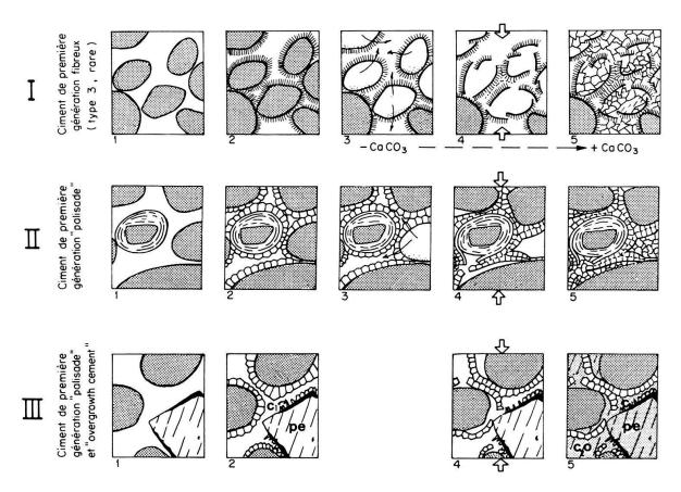
Fig. 4. Essai de reconstitution de quelques phénomènes de diagenèse jeune dans le calcaire graveleux (Jurassique moyen, massif de la Haute-Pointe).
