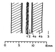
Fig. 4. «Kupferader». – Makroskopische Untersuchung am Anschliff. 1 = metallisch glänzende, kupferfarbene Ader; 2 = dunkle Randzone; 3 = «normale» Sandsteinpartie; 4a = ockerfarbene Zone; 4b = rötlichbraune Zone.
