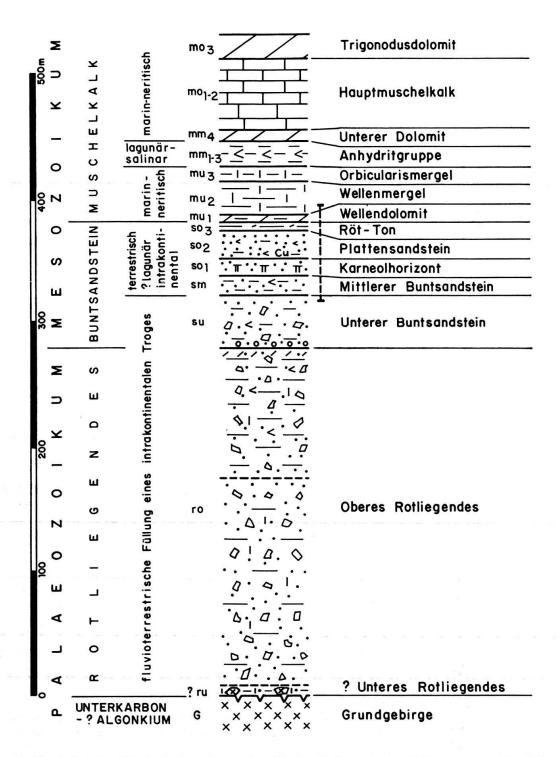
Fig. 2. Vereinfachtes lithologisches Sammelprofil der Sedimente im Felsuntergrund östlich von Kaiseraugst (Kt. Aargau). Gestrichelte, senkrechte Linie = Bereich der Kernbohrungen im Standort des geplanten Kernkraftwerks.
