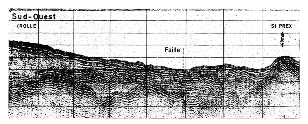
Fig. 6. Passage de l'accident de Pontarlier-Vallorbe dans la molasse au large du delta de l'Aubonne.
