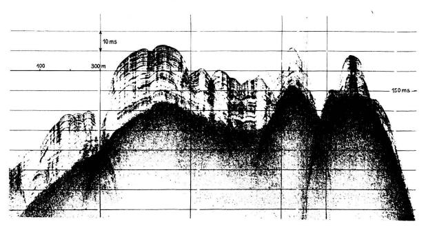
Fig. 8. Fluage lent des sédiments lacustres sur le substratum rocheux (côte suisse).
