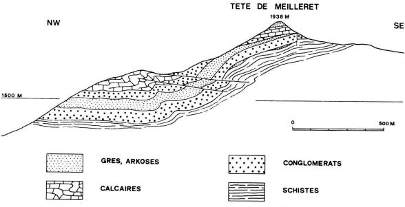
Fig. 11. Coupe structurale à travers le flysch du Meilleret à l'est du Chamossaire.
