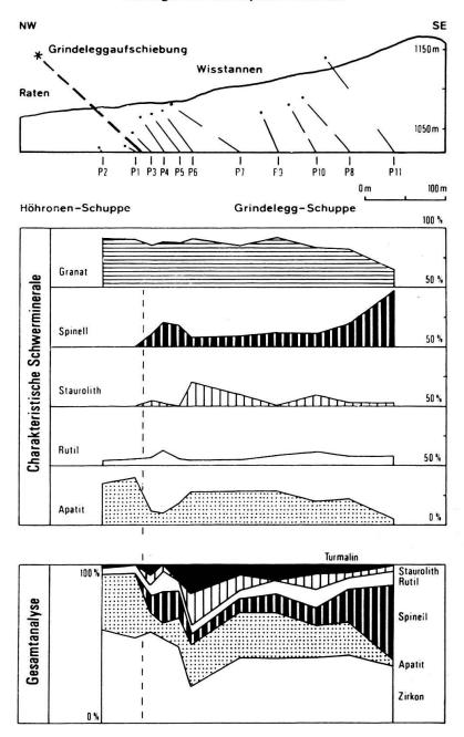
Fig. 6. Das Wisstannen-Profil: Schwermineralanalyse.
