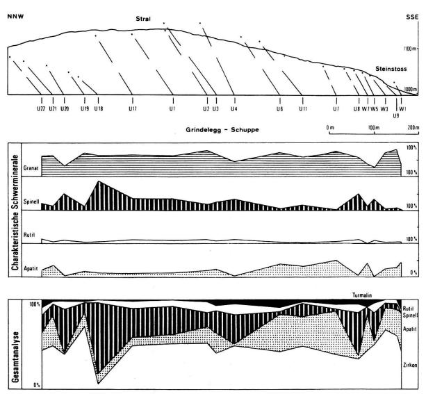
Fig. 5. Das Steinstoss-Frofil: Schwermineralanalyse.
