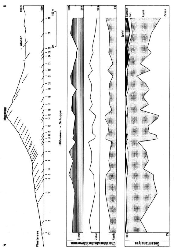
Fig. 7. Das Finstersee-Alosen-Profil: Schwermineralanalyse.
