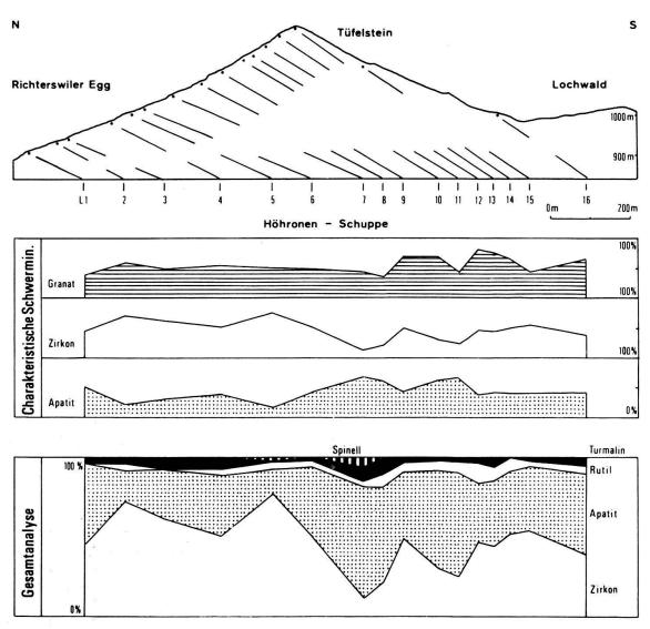
Fig. 9. Das Tüfelstein-Profil: Schwermineralanalyse.
