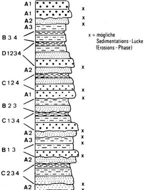
Fig. 28. Beispiel einer Zyklenabfolge in der Subalpinen Molasse.
