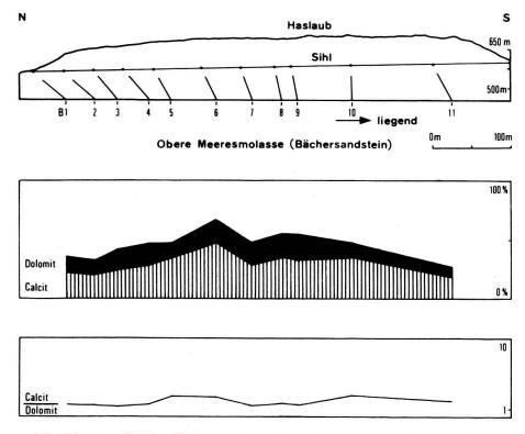
Fig. 20. Das Sihl-Profil (etwa 1 km NW Finstersee): Karbonatanalyse.
