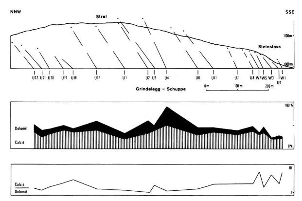
Fig. 14. Das Steinstoss-Profil: Karbonatanalyse.
