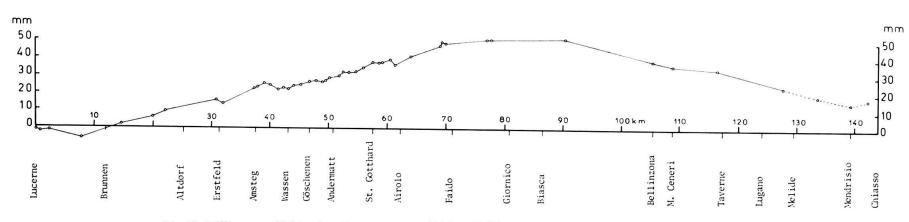
Fig. 2. Différences d'altitudes obtenues entre 1918 et 1969/70 par comparaison des repères scellés dans la roche en place entre Lucerne et Chiasso. En pointillé les résultats de la région de Chiasso où les repères ne sont pas dans des roches en place.
