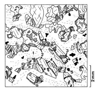
Fig. 6. Dünnschliffzeichnung des Diorits vom Piz Val Gronda. (Nummern vergleiche den Text der Dünnschliffbeschreibung!)
