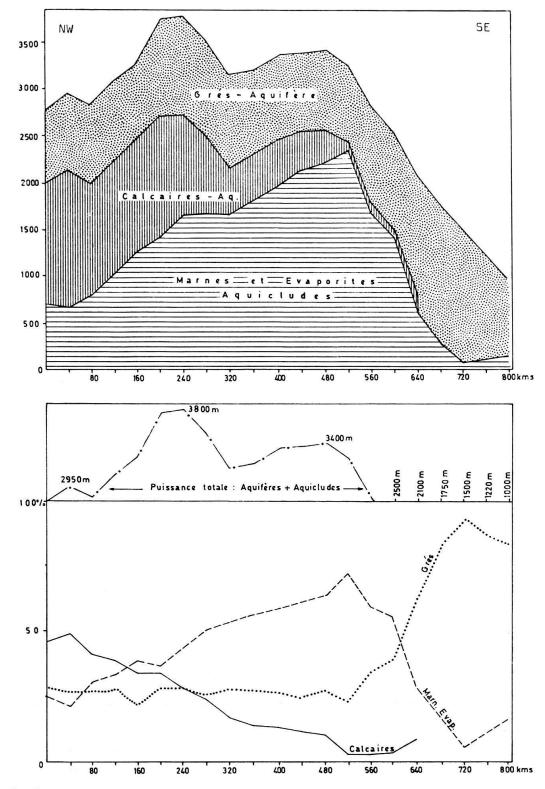
Fig. 6. Diagrammes montrant la relation quantitative entre grès aquifères, calcaires et aquicludes du Continental intercalaire.
