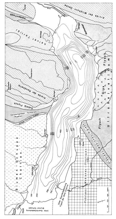
Fig.4. Thunersee mit Isohypsen der Felsoberfläche und geologisch-tektonischem Rahmen. Bezugshorizont ist die Seeoberfläche.
