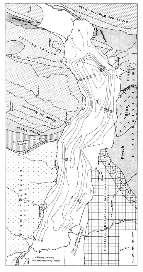
Fig. 6. Isopachenkarte der quartären Lockergesteine. Bezugshorizont: Seeoberfläche.
