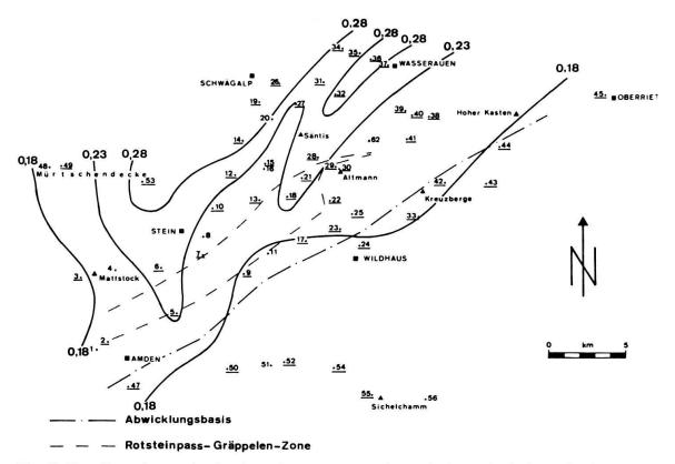
Fig. 40. Verteilung der maximalen Quarzkorngrössen an der Basis des Helvetischen Kieselkalkes. (Die unterstrichenen Profile dienten als Grundlage dieser Figur. Unterlage abgewickelt.)
