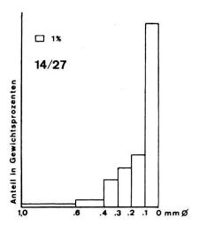
Fig. 27. Kornverteilungsdiagramm des detritischen Quarzes im glaukonitischen Kalk der Probe 14/27.
