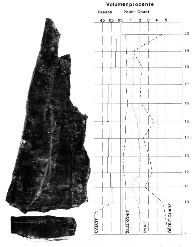
Fig. 30. Kleinzyklus aus der Schicht 47/6<sub>10</sub>. Abbildung des AS und Volumenprozente einiger Anteile (Photo: M. Zuber).
