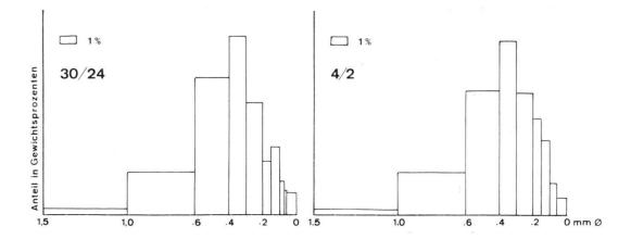
Fig. 24. Kornverteilungsdiagramm der Proben 30/24 und 4/2 aus den Pygurusschichten.
