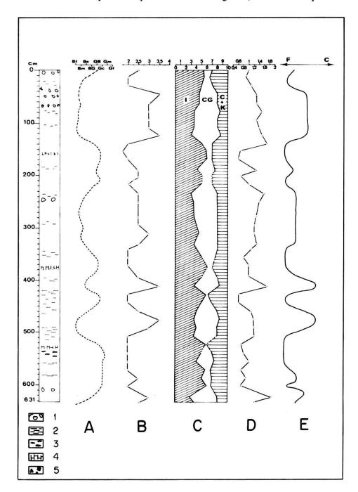
Fig. 3. Log des textures: 1 fragments de roches, 2 tachetures, 3 traînées noires, 4 aspect crayeux, 5 lit à Foraminifères.
