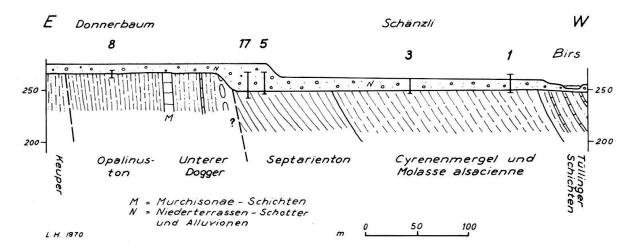
Fig. 2. Geologisches Profil durch die Rheintalflexur im Schänzli bei Muttenz. Profil entlang der im Zusammenhang mit dem Nationalstrassenbau neu angelegten Birsfelderstrasse unter Berücksichtigung der Aufschlüsse und Sondierbohrungen.
