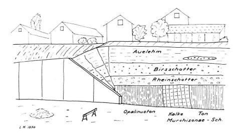
Fig. 1. Steilstehendes Mesozoikum an der Rheintalflexur beim Schänzli, Gemeinde Muttenz. Baustelle Birsfelderstrasse, Blick auf die künstlichen Aufschlüsse neben der Stützmauer unterhalb der Schweizeraustrasse.
