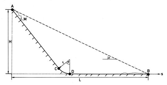
Fig. 2. Prinzipskizze zum Modell der geschwindigkeitsabhängigen Reibung.
