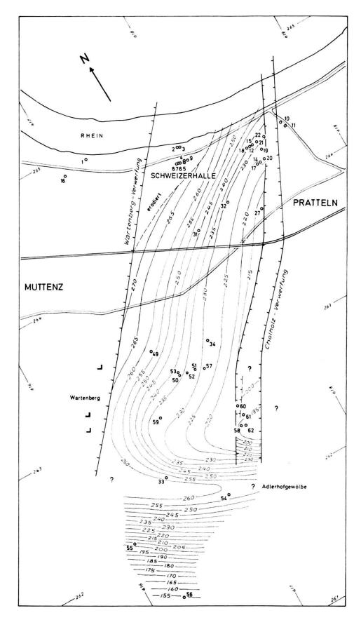
Fig. 6. Strukturkarte auf die Grenze Trigonodusdolomit-Lettenkohle (in m ü. M.), 1:25000.
