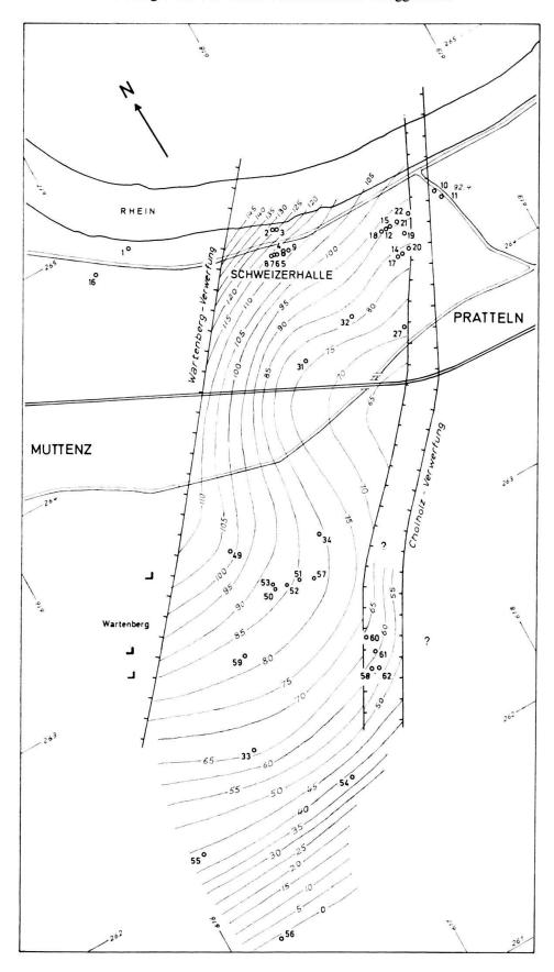
Fig. 3. Strukturkarte der Salzbasis (in m ü. M.), 1:25000.
