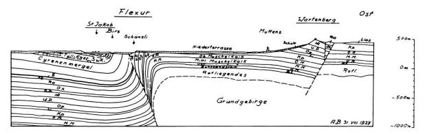
Fig. 1. Rheintalflexur und Tafeljura nach Buxtorf (1928). Die Figur ist etwas schematisch, gibt aber die steile bis überkippte Lage der Schichten in Flexurnähe sowie die Andersartigkeit der Tafeljura-Abschiebungen (Wartenberg) trefflich wieder.
