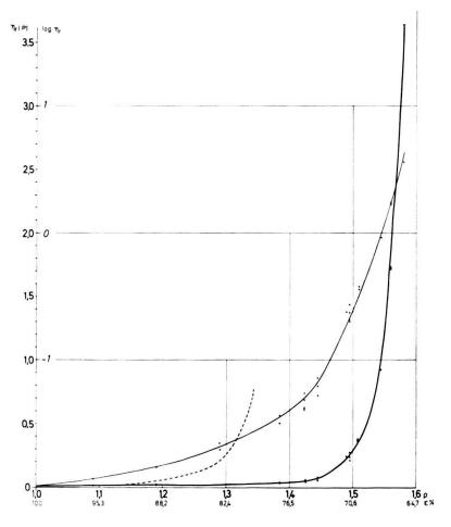
Fig. 20. Rechnerische Zähigkeit von pelitischen Kalksuspensionen (Schlämmkreide) in Abhängigkeit von der Dichte, d.h. der Volumenkonzentration. Dünne Kurve oben: Zähigkeit im logarithmischem Maßstab. – Gestrichelte Kurve: Zähigkeit von Tonsuspensionen in Abhängigkeit von der Dichte nach Kuenen (1951), Maßstab linear.
