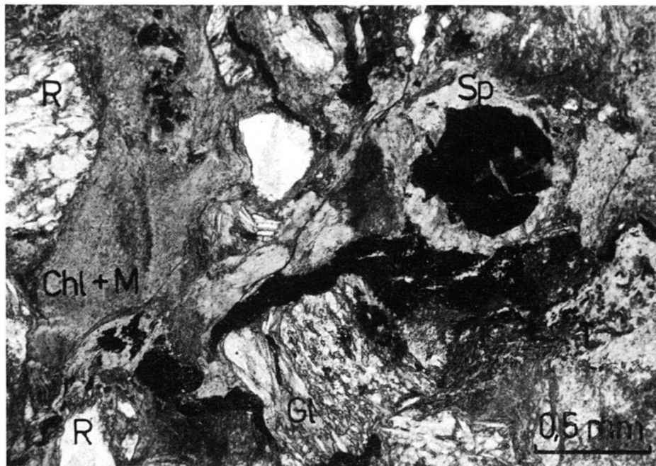
Fig. 4. Polygene Radiolaritbreccie. In grüner, feinfilziger Matrix (Ripidolith (Chl), Muskovit (M), Hämatit und Titanit (T)) liegen kleine Radiolaritbruchstücke (R), Quarzit und Glimmerschieferkomponenten (grau mit Paralleltextur, Gl) sowie Spinellkörner (schwarz, meist Magnetit, Sp). Vergrößerung 35 \times , ohne gekr. Nicols.
