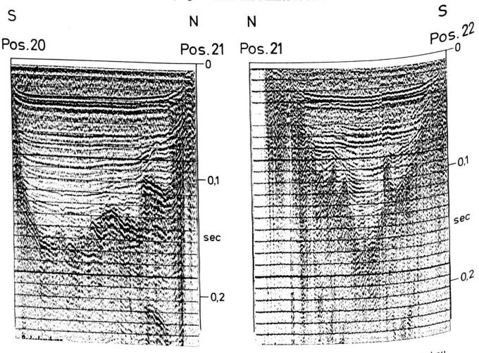
Fig. 7. Seismisches Querprofil Meilen-Stäfa.
