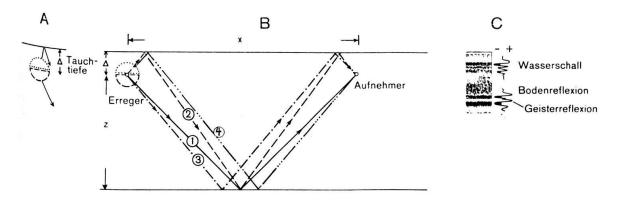
Fig. 5A. Darstellung des primär nach unten laufenden und des an der Grenzfläche Wasser-Luft reflektierten Druckstosses.
