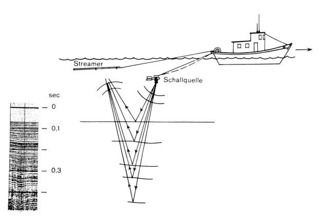
Fig. 1. Schematische Darstellung des Messvorganges. Das mit Registriereinrichtungen ausgerüstete Schiff schleppt die seismische Schallquelle und das Streamer Messkabel mit konstanter Geschwindigkeit über Grund.
