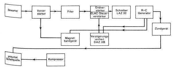
Fig. 4. Schema des Messvorganges.
