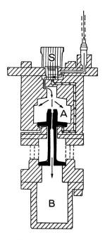
Fig. 3. Pneumatische Schallquelle: A Steuerkammer, B Speicherkammer, S Magnetventil.
