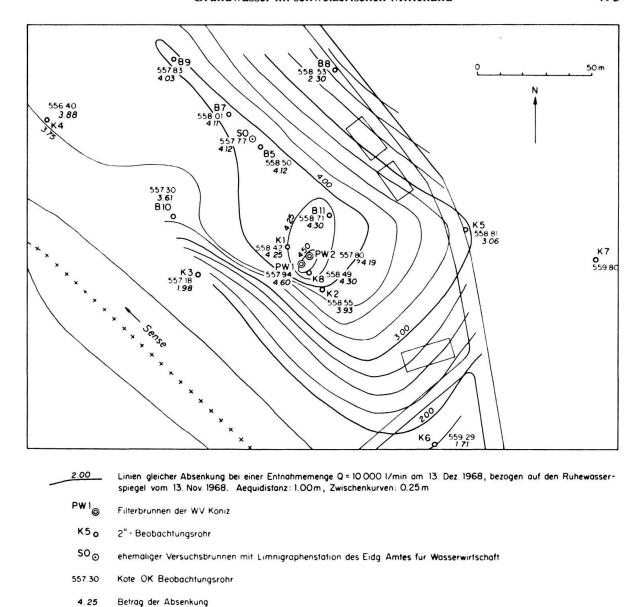
Fig. 5. Sensematt-Au, Produktionsbrunnen: Linien gleicher Absenkung bei einer Entnahmemenge  $Q=10000\ l/min$  am 13.12.1968.
