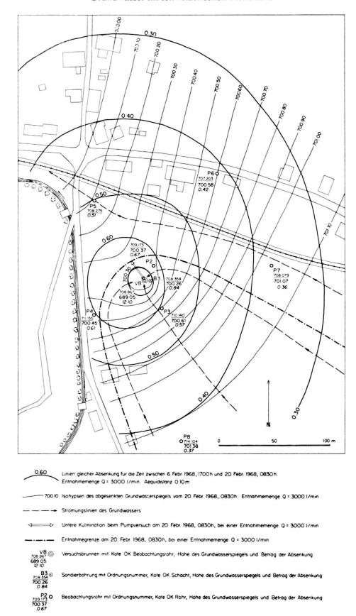
Fig. 7. Pumpversuche im Versuchsbrunnen Grossacher/Bowil: Isohypsen des abgesenkten Grundwasserspiegels am 20.2.1968. Linien gleicher Absenkung für die Zeit zwischen 6. Februar 1968, 17.00 h, und 20. Februar 1968, 08.30 h. Entnahmemenge Q = 3000 l/min.
