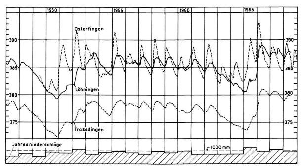
Fig. 3. Grundwasserganglinien im Klettgau (Löhningen und Trasadingen) und Wangental (Osterfingen) 1947–1968.
