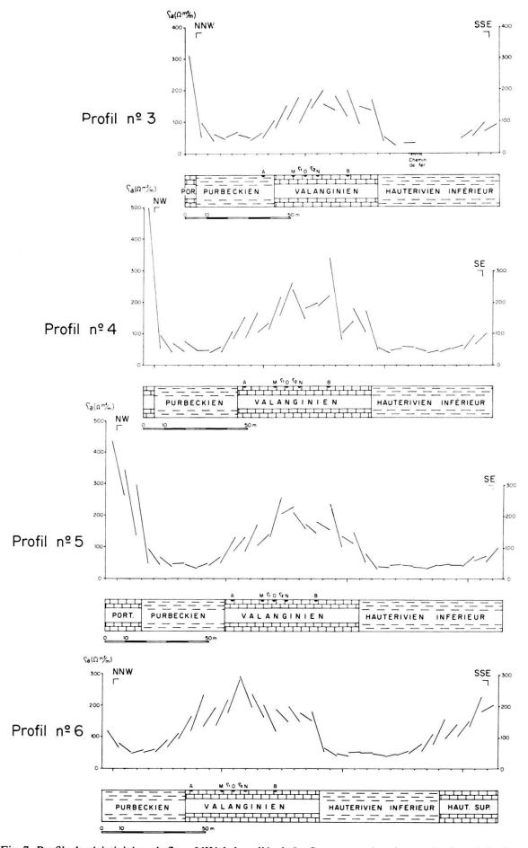
Fig. 7. Profils de résistivité sur le flanc NW de la vallée de La Sagne, avec leur interprétation géologique.
