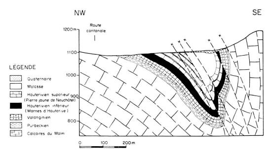
Fig. 4. Profil géologique à travers la vallée de La Sagne. Situation: la même que pour le profil de résistivité No 1.
