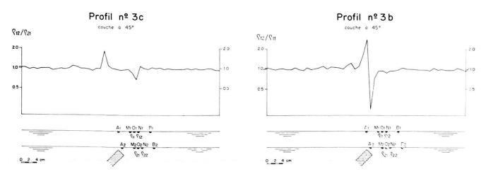
Fig. 3. Profils de résistivité sur modèle réduit. Couche résistante à 45°; divers modes de représentation: a)  $\varrho_1$  et  $\varrho_2$  reportés à mi-distance entre deux électrodes de potentiel. b)  $\varrho_{12}/\varrho_{11}$  reporté en 0. c)  $\varrho_{12}/\varrho_{21}$  reporté à mi-distance entre deux électrodes de potentiel.
