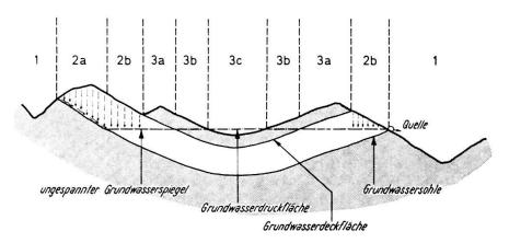
Fig. 6. Querschnitt durch einen Grundwasserleiter mit Synklinalstruktur.
