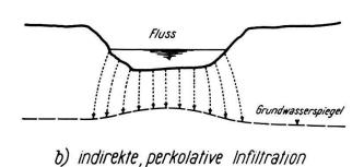
Fig. 5. Typen von Infiltration von Flusswasser ins Grundwasser.
