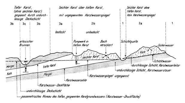
Fig. 7. Querschnitt durch einen Karstgrundwasserleiter mit Isoklinalstruktur.
