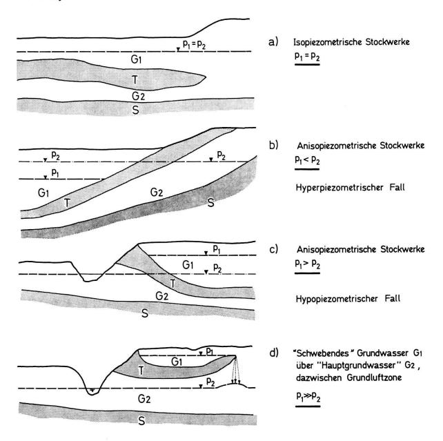
Fig. 8. Grundwasserstockwerke unter verschiedenen Druckverhältnissen. G1 = Oberes Grundwasserstockwerk mit Druckniveau  $p_1$ ; G2 = Unteres Grundwasserstockwerk mit Druckniveau  $p_2$ ; T = Undurchlässige Trennschicht; S = Undurchlässige Sohle unter G2.
