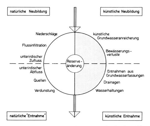
Fig. 3. Graphische Darstellung der verschiedenen Posten einer Grundwasserbilanz.
