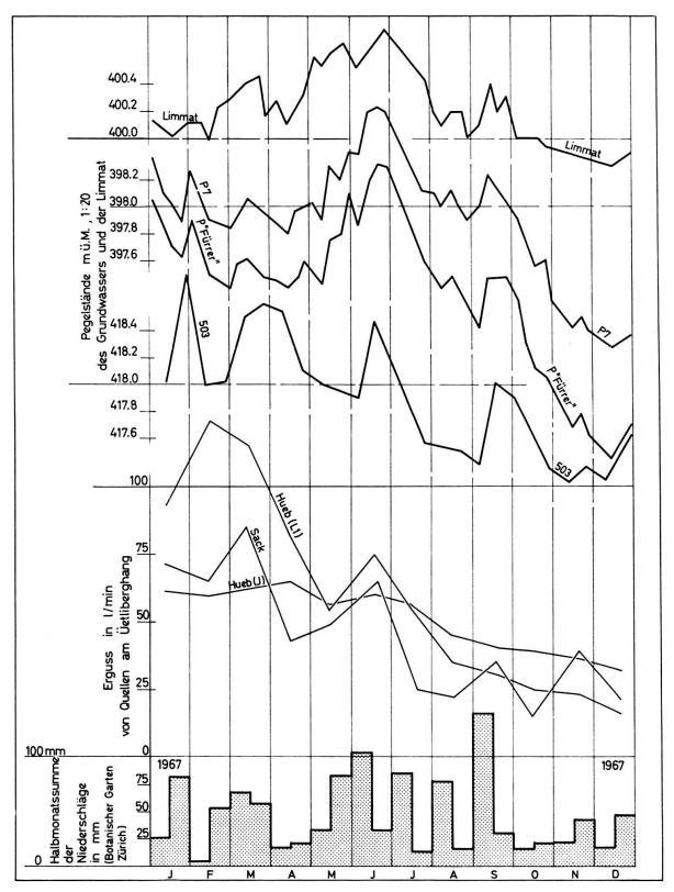
Fig. 9. Ganglinien 1967. Von oben nach unten: Pegelstände der Limmat beim Escher-Wyss-Platz Zürich. P7: Piezometerrohr im Grundwasser beim Escher-Wyss-Platz. P «Fürrer»: Piezometerrohr im Geschäftshaus Rud. Fürrer Söhne AG, Hardturmstrasse 76. 503: Piezometerrohr in der Allmend Brunau, Hangfuss Üetliberg. Hueb L1, Hueb J und Sack: Erträge von Moränenquellen der Wasserversorgung Zürich am Üetliberghang. Daten WVZ. Halbmonatssummen der Niederschläge beim Botanischen Garten Zürich. Daten MZA.
