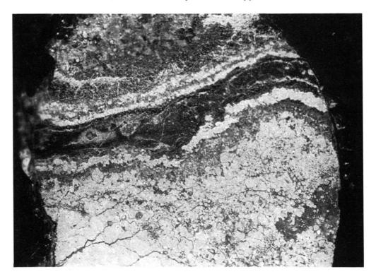
Fig. 5. CHD 37/2. Grossissement 10 x. Filon de pechblende entouré de la pyrite.
