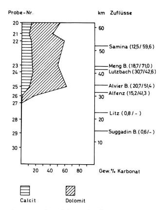
Fig. 11 Karbonatführung der Ill.
