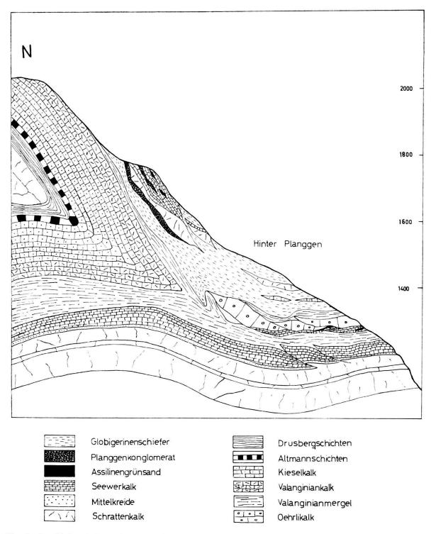
Fig. 2 Profil durch den mittleren Teil der Planggen. An der Basis sieht man Schrattenkalk bis Seewerkalk der Mürtschen-Decke, darüber Valanginianmergel, die von der Wiggis-Teildecke herzuleiten sind, dann der Öhrlikalkspan mit basalen Seewerkalkschuppen, zu den Planggen-Schuppen gehörig. Darüber mehrere Planggen-Schuppen, die in Globigerinenschiefer stecken. Rechts im Profil die spitze südlichste Synform der Wiggis-Teildecke. Maßstab 1:10000.
