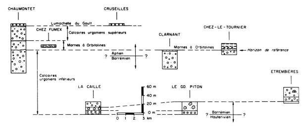
Fig. 5 Corrélations lithologiques dans le pli du Salève. Légende: voir la fig. 3, p. 11.
