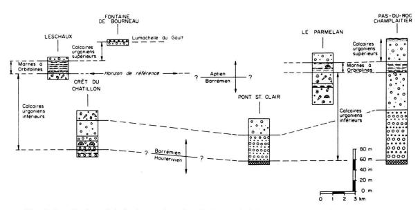
Fig. 6 Corrélations lithologiques dans les chaînes subalpines. Légende: voir la fig. 3, p. 11.
