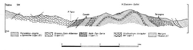
Fig. 1. Profil durch den M. Zuccone-Sattel bei Bedonia (Prov. Parma). In den Macigno (Toskaniden II (?)) schalten sich zunächst Olisthostrome aus dem Material der Liguriden I ein, ehe die Gleitdecken der Liguriden I-III eintreffen.
