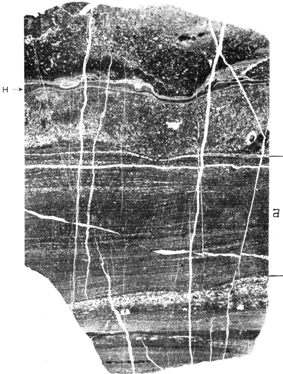
Fig. 15. Niveau de transgression à la base de la formation spathique, au Sud de l'Anticlinal II. a faciès des Couches de Kössen remanié dans un galet allongé dont les extrémités ne sont pas visibles sur la photo. H hard ground. Grossissement 3 ×. Echantillon Gi. 800.
