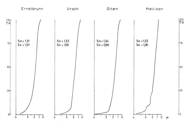
Fig. 1. Korngrössenverteilung der untersuchten Mikrite. Die Summenkurven spiegeln die gleichen Korngrössenbereiche und die gleichartige Sortierung der Kalke wider.
