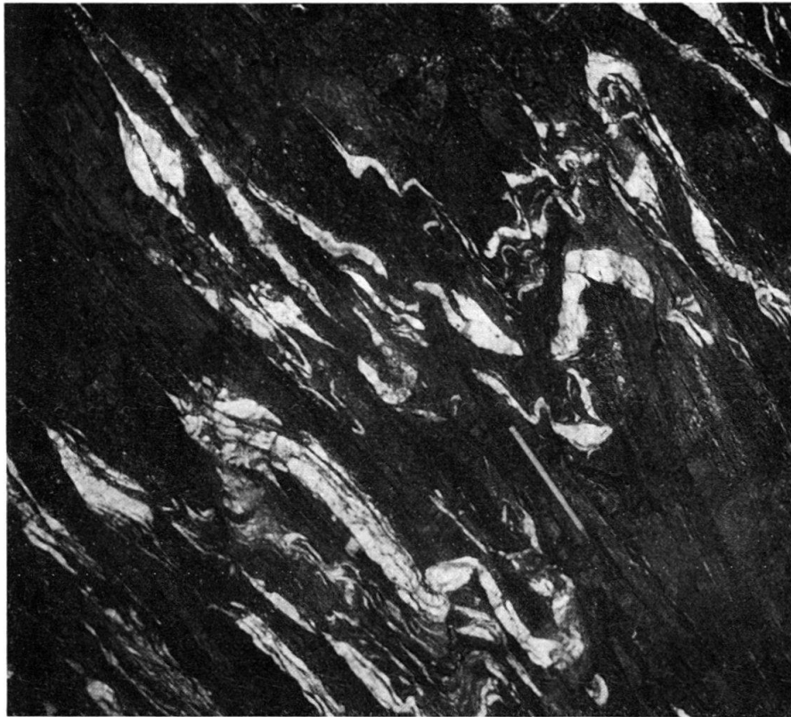
Fig. 7. Im Malmkalk des Pfaffenkopfskeils wird eine erste Schieferung (mit parallelen Calcitlagen) durch eine zweite, steilere gefaltet. Druckstollen Trift-Speicherberg, m 2720 ab Trift.
