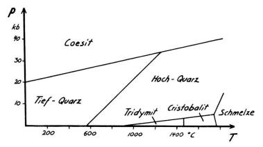
Fig. 2. System SiO<sub>2</sub>, Zustandsdiagramm (nach Boyd und England, 1960).
