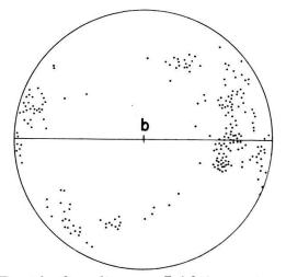
Fig. 5b. Quarzlinse aus Injektionsgneiss, N Pte. Brolla am Kanal. 306 [0001] von Quarz, ac-Schnitt (aus H. R. Wenk, 1965).
