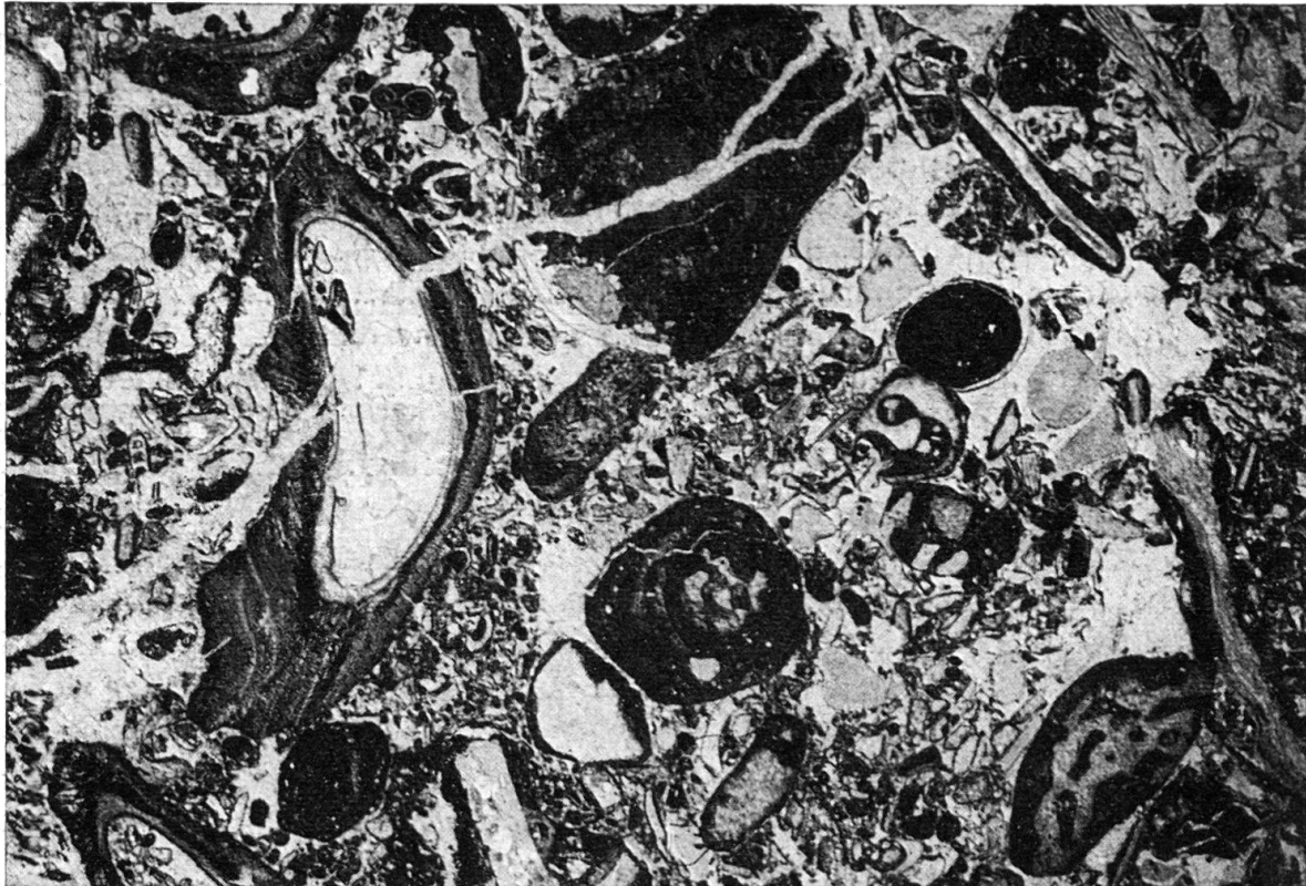
Fig. 31. Feine Kalkarenite; Basale Partien mit schlecht sortierten, z.T. groben Fossiltrümmern, die mehrheitlich von Algen umkrustet sind. In der Mitte einzelne Mumie. Montmelon dessus.
