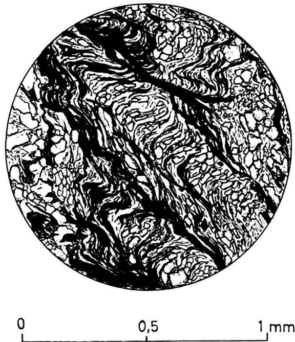
Fig. 17. Dünnschliff eines verfältelten serizitischen Tonschiefers mit Clivageflächen.
