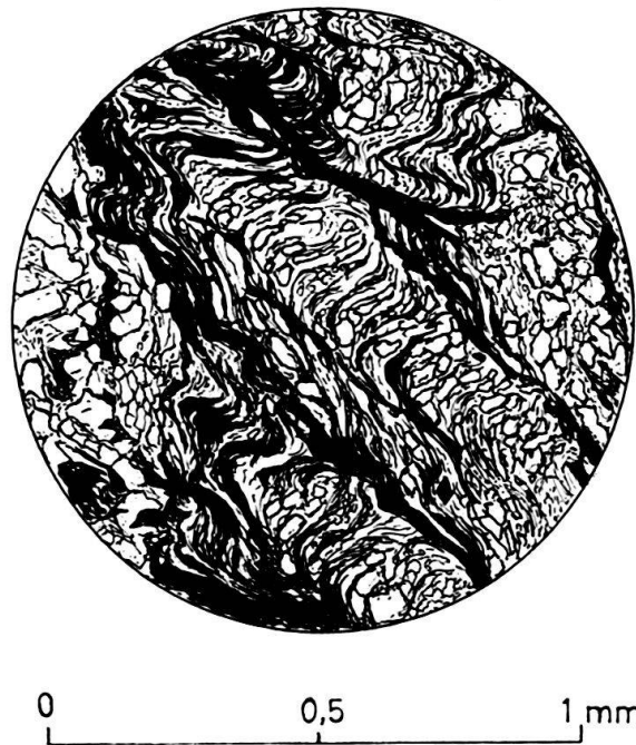
Fig. 17. Dünnschliff eines verfältelten serizitischen Tonschiefers mit Clivageflächen.
