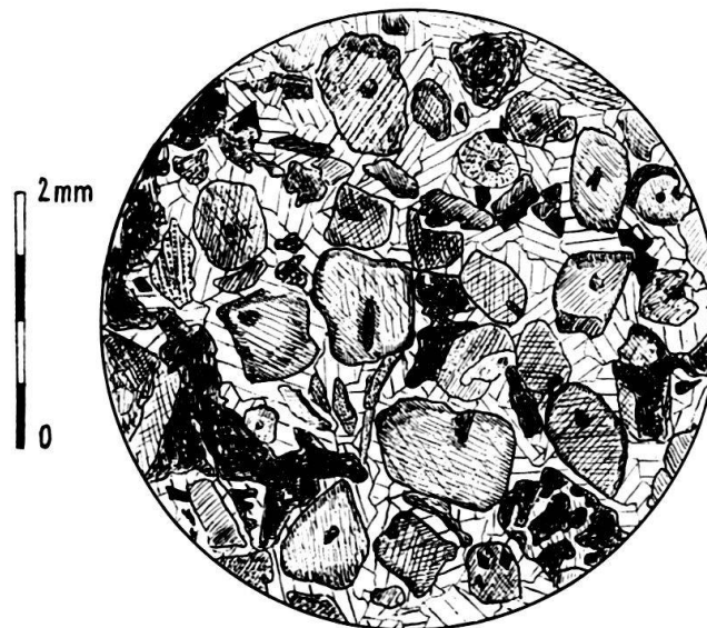
Fig. 16. Dünnschliff von grauer Echinodermenbreccie (beachte die Kontinuität der Kalzitlamellen der Grundmasse).
