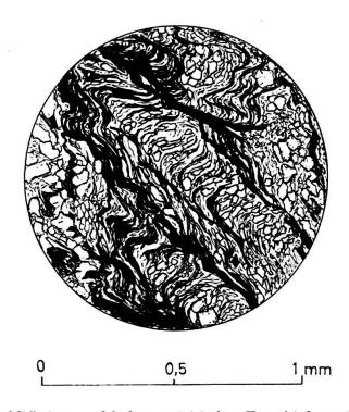
Fig. 17. Dünnschliff eines verfältelten serizitischen Tonschiefers mit Clivageflächen.
