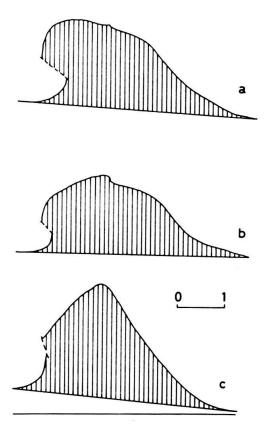
Fig. 39. Verkürzungen in der Reculet- (a, b) und der Crêt de Chalam-Antiklinale (c) (nach Schardt aus DE MARGERIE 1936, p. 1176 und 1180).
