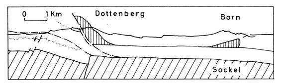
Fig. 15. Verkürzungen in der Dottenberg- und der Bornkette (nach A. Buxtorf 1916, Profil des Hauensteinbasistunnels, Tiefenstruktur des Born-Südschenkels etwas modifiziert).
