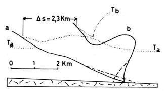
Fig. 9. Die Verfaltung der Grenchenbergüberschiebung (nach Buxtorf 1916, Tafel III) ausgezogen: Überschiebung (a = vor, b = nach Verfaltung); punktiert: Tertiärbasis ( $T_a = vor$ ,  $T_b = nach Verfaltung der Überschiebung); gestrichelt: modifizierter Verlauf der Überschiebung, um ihre Zusammenstauchung auf das geforderte Mass zu vergrössern.$
