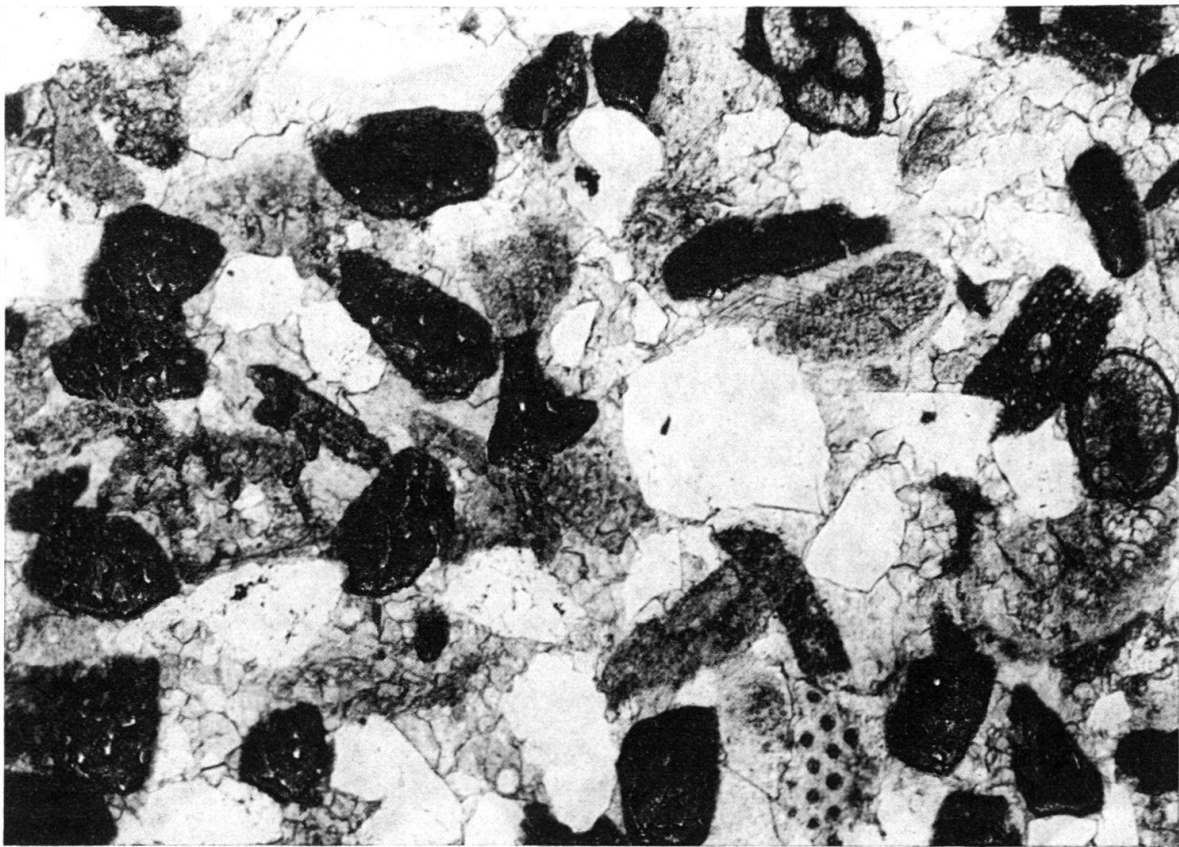
Fig. 16. Ampfing Sandstein . DS 2813. Hell = Quarz und Feldspat; grau = Calcitcement mit Echinodermen, Bryozoen und Foraminiferen (z.T. schwarze Kammerwände). Schwarz: Lithothamnienschutt. (Schmalseite = 1,7 mm).
