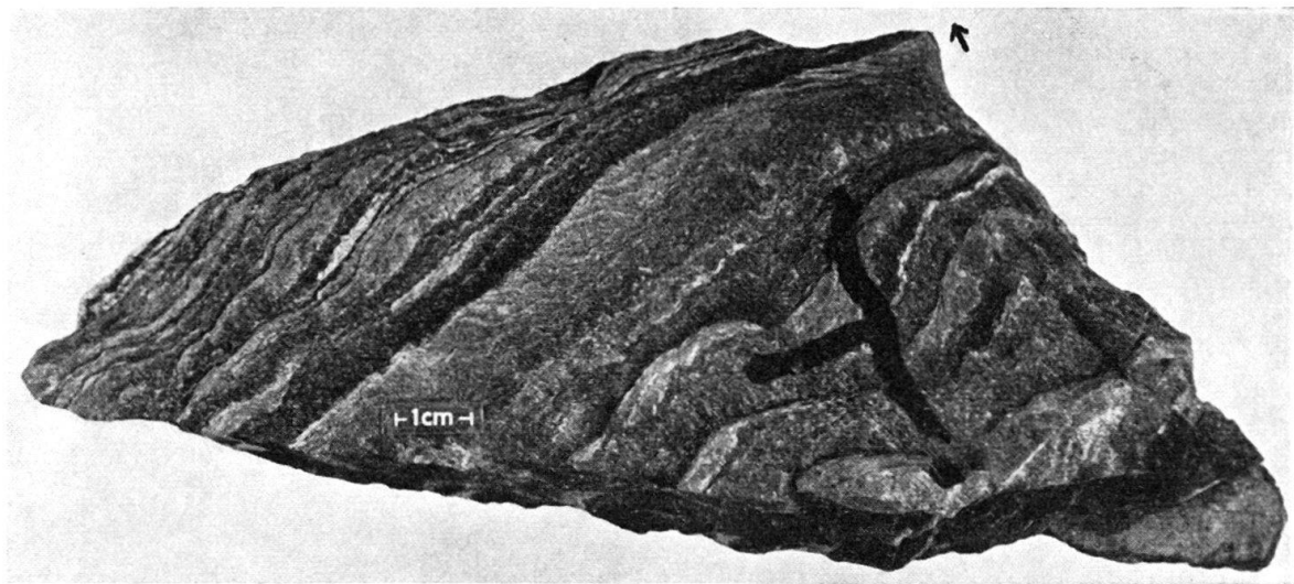
Fig. 7a. Gradierung in Rhythmit, – 60m nördlich des Lawinendachs, das an der Strasse Ilanz–Peidenbad beim Kilometerstein 4 liegt –, an der Oberseite der kieslig-sandigen Serie. Die rhythmische Schichtung im mm- bis cm-Bereich zeigt z. T., Gradierung (Pfeil deutet nach unten) und linsiges Auskeilen. Die photographierte Fläche liegt s_2 fast parallel, die Schnittgerade ss/s_2 streicht NW. ss ist hier um eine B_2 -Falte (abwickelbar) verbogen. Trotzdem sind die Feinheiten der Schichtung noch gut erkennbar. Die feine, ss durchziehende Bänderung ist durch metamorphe Bänderung parallel s_2 geschaffen und hier schräg angeschnitten.
