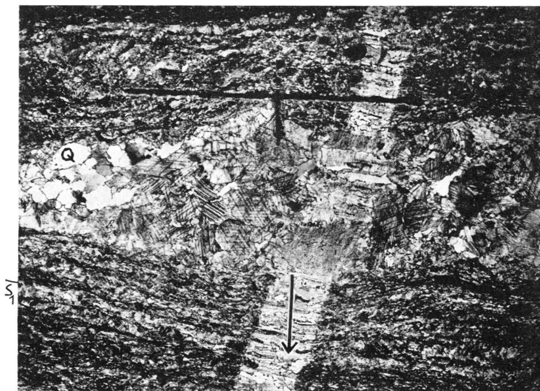
Fig. 9. Crinoiden-Kalk, kieslig-sandige Serie (Koord. 736,05/178,5, wie Fig. 5 und 8b). Ein in s_1 liegender Gang mit grobem Karbonat (stark verzwilligt) und Quarz (Quarz deformiert und teilweise rekristallisiert) ist von einem jüngeren Gang durchsetzt, der fast senkrecht auf str_1 steht. Dieser jüngere Gang wurde sukzessive gefüllt, während er geöffnet wurde. Impfung durch die Wand-Kristalle ergibt gröbere Kristall-Füllung, wo der jüngere Gang den älteren durchsetzt. Faserbildung parallel zur Öffnungsrichtung. Vergr. 4\times . Pfeil=geographisch unten.
