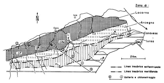
Fig. 1. Cartina geologica del versante meridionale delle Centovalli (circa 1 : 100 000) con il tracciato della galleria degli Impianti idroelettrici della Maggia.
