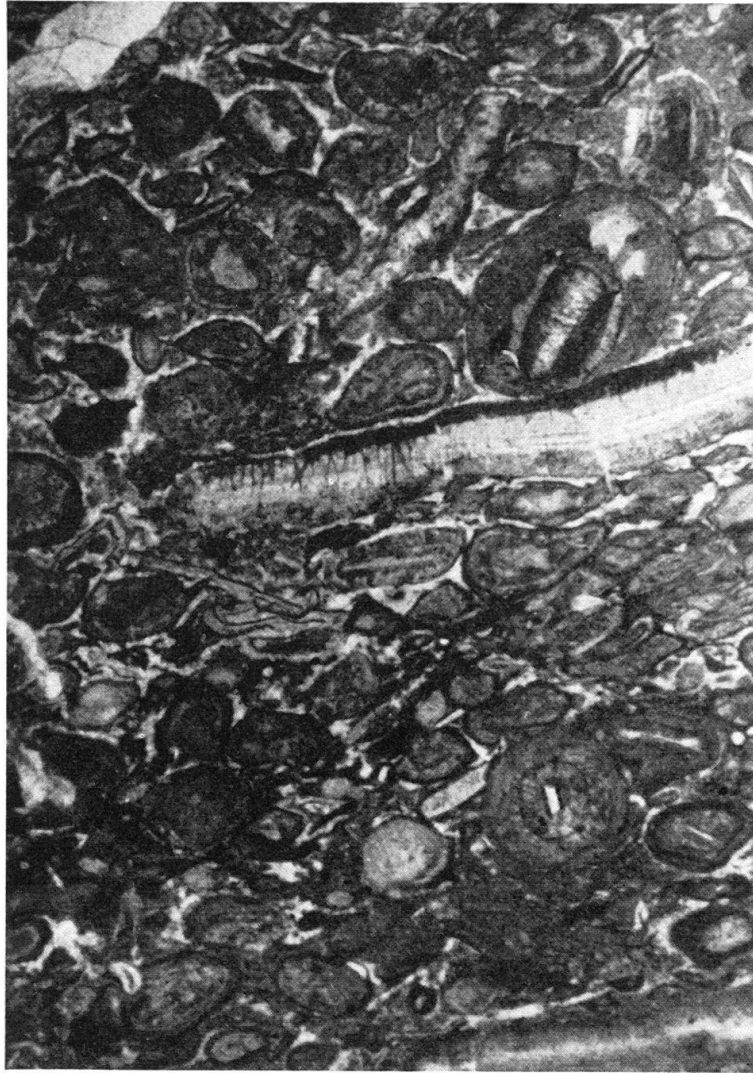
Fig. 13. S. Agata Nr. 19. Biogener Calcit (von Cyanophyceen ?) nimmt grossen Anteil am Gefüge: in der Grundmasse, um korrodierte Bivalvenschalen, in Ooiden. Die Ooide sind meistens para-diagenetisch plastisch deformiert, in schlierigen Bereichen besonders stark. 20×.
