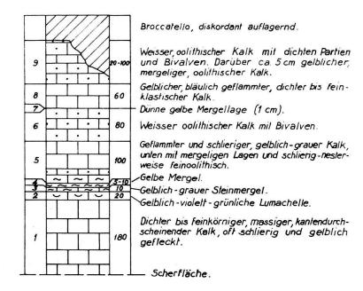
Fig. 18. Stratigraphisches Profil des Rhät-Daches in der NW-Ecke des grossen Steinbruchs von Arzo (E/11 auf Taf. IV), 1:100. Links Schichtnummern, rechts Mächtigkeiten in cm.
