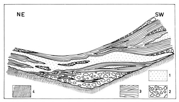
Fig. 5. Synthèse stratigraphique schématique du Carbonifère de la base du synclinal. 1 = Sédiments arénacés, 2 = Conglomérats, 3 = Sédiments fins, 4 = Socle cristallin
