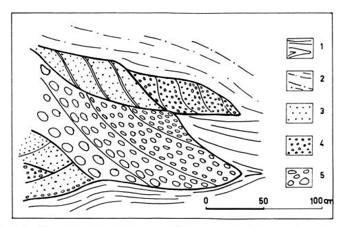
Fig. 3. Carbonifère d'allure lenticulaire. 1 = Schistes noirs, 2 = Schistes gréseux, 3 = Grès, 4 = Microconglomérats, 5 = Poudingue
