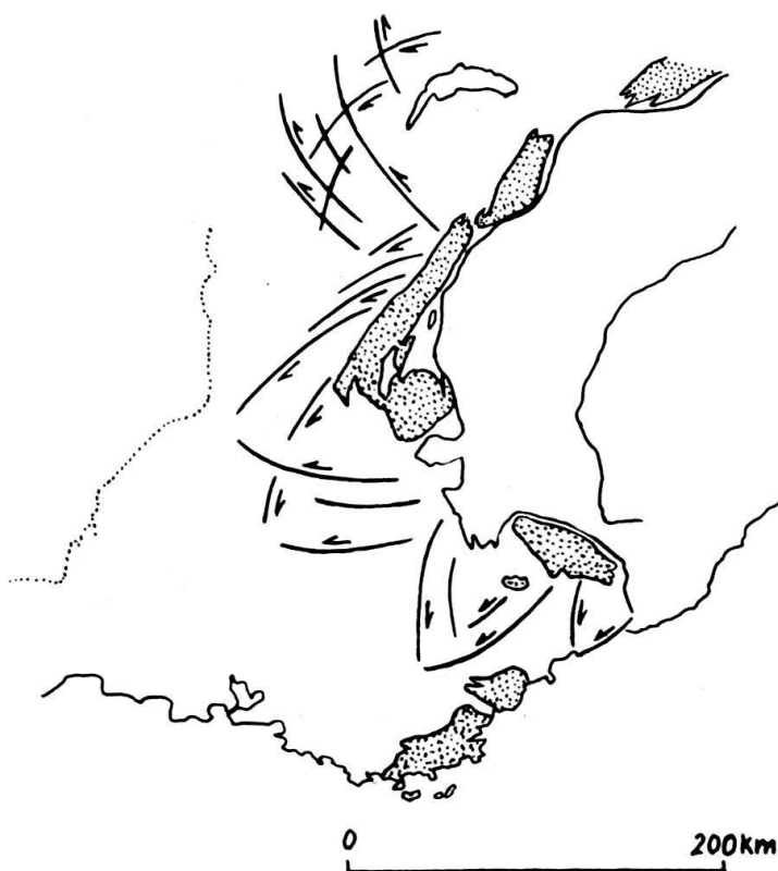
Fig. 8. Schematisch vereinfachte Grundzüge eines tektonischen «Halbsterns» von Horizontalverschiebungen im Gebiet der Chaînes Subalpines wie sie auf Grund einer Analyse nach dem Prinzip der HV-Faltung vermutet werden können.
