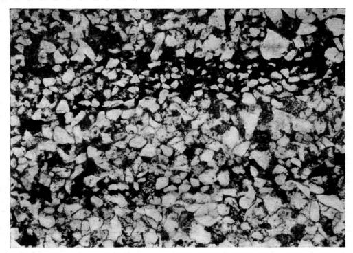
Fig. 21. Dünnschliff aus der unmittelbaren Nachbarschaft der Schnittebene von Fig. 19 mit linearen, tonigen Scherzonen. Diese, auf Fig. 19 sehr scharf definiert, erscheinen bei Vergrösserung immer noch etwas diffus. Sie sind ausgezeichnet durch feine, mit der tonigen Matrix eingedrungene Quarz- und Kalkkörner und zeigen, im Gegensatz zu Fig. 20, keine Zerscherung der Quarzkörner, entstammen also einer Phase geringer Kompression oder noch relativ hohen Porendruckes.  $30 \times$ .
